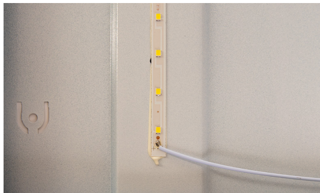
Эффективный отвод тепла от светодиодов обеспечен надежным креплением LED линеек к металлическому корпусу светильника с использованием термопасты
